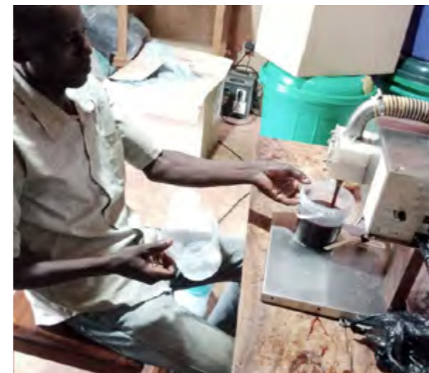
Mit einer programmierbaren Maschine wird der Honig in Plastikbehälter (1.500g, 500g, 250g und 30g) gefüllt.
